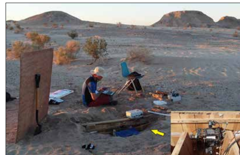
Kontrola dilatometru TM71 s automatizovaným záznamem posunů na zlomu Superstition Hills na monitorovací stanici Imler v jižní Kalifornii. Foto: Petra Štěpančíková ÚSMH AV ČR
