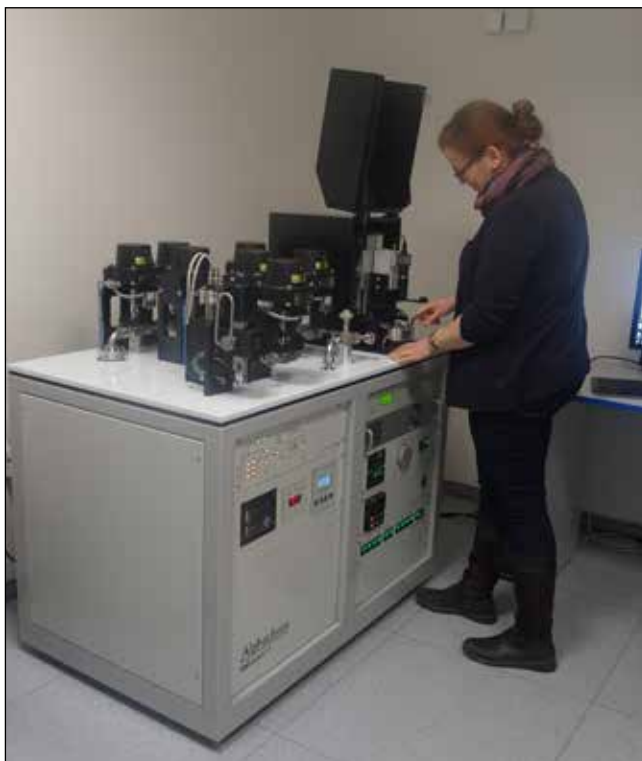
Hmotnostní spektrometr Alphachromt určený pro heliovou termochronologii, který disponuje automatizovanou extrakcí radiogenního hélia a měřením jeho obsahu ve vzorcích minerálů. Foto: Petra Štěpánčíková ÚSMH AV ČR
