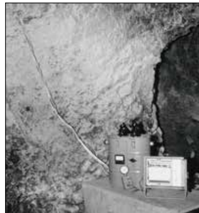
Měření tepelných parametrů hornin v pokusné štolě ve Velké Chuchli, bez datace, foto: autor neuveden ÚSMH AV ČR, sbírka fotografií
