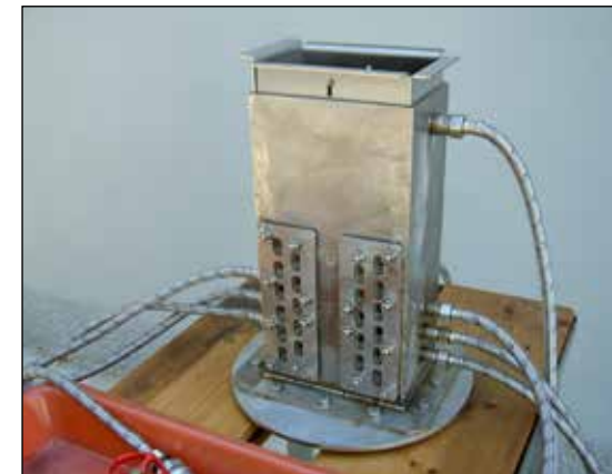
Aparatura pro sestavování magnetů do bloků s vysokými hodnotami magnetického pole, patentovaná v USA ÚSMH AV ČR
