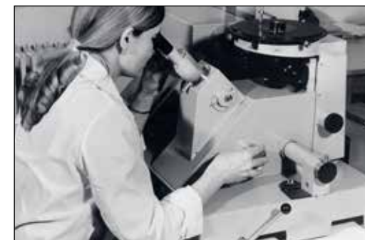
Jadwiga Plocková proměřuje preparát hnědého uhlí v polarizovaném světle (klasifikace uhlí pro tlakové zplyňování), bez datace, foto Renáta Louvarová (Záběhlická) ÚSMH AV ČR, sbírka fotografií
