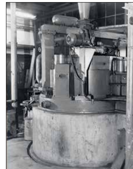
Model horizontálního prstencového lisu pro formování uhlí při velmi vysokém tlaku 200 až 300 MPa, bez datace, foto Renáta Louvarová (Záběhlická) ÚSMH AV ČR, sbírka fotografií
