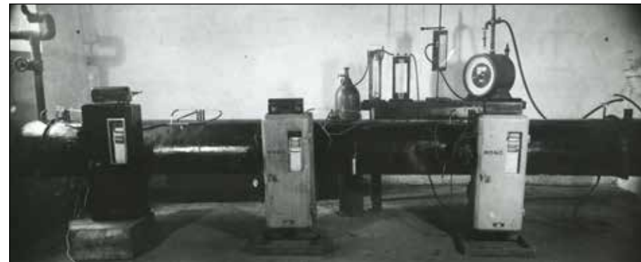
Studium difuze metanu a CO 2 bylo prováděno ve svislých válcích nebo ve vodorovné laboratorní štolě, plynové oddělení. Fotografie z výroční zprávy ústavu za rok 1952 NA, fond MPE, k. 110, inv. č. 84
