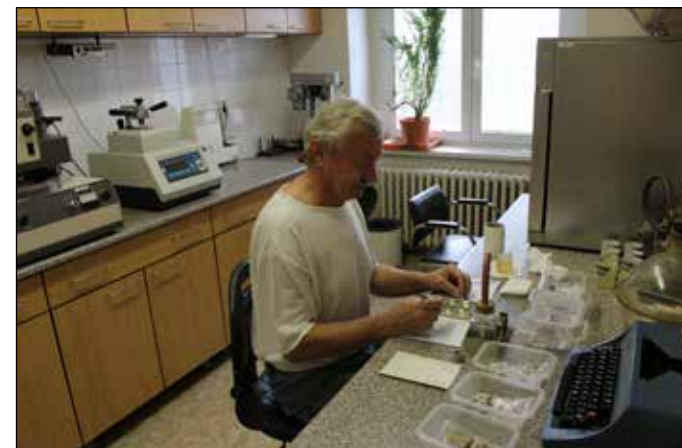
Alexandr Šulc během přípravy nábrusů pro studium mikroskopických parametrů. Foto: Vlasta Mádllová
