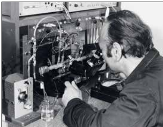
Měření mikroforetické pohyblivosti koloidních částic, na snímku Milan Dočkal, bez datace, foto Renáta Louvarová (Záběhlická) ÚSMH AV ČR, sbírka fotografií
