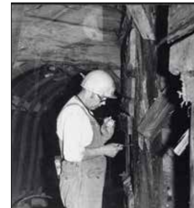
Robert Brož při měření puklin geologickým kompasem, Uhelné doły Příbram, bez datace, foto: Renáta Louvarová (Záběhlická) ÚSMH AV ČR, sbírka fotografií
