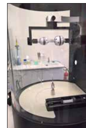
Zařízení 4SPIN (Contipro a.s.) je využíváno pro elektrostatické zvláknění polymerních roztoků, zejména polymerů přírodního původu, jako je kolagen, či pro pokryv implantátů (na snímku jsou jamky totální náhrady kyčelního kloubu)
