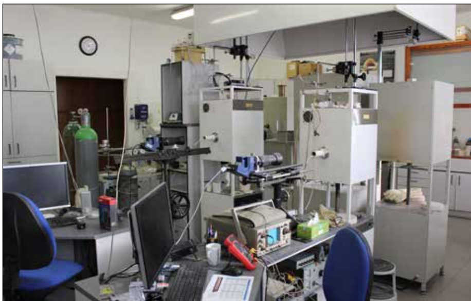
Laboratorní pece pro vysokoteplotní pozorování procesů ve sklovinách Foto: Vlasta Mádllová
