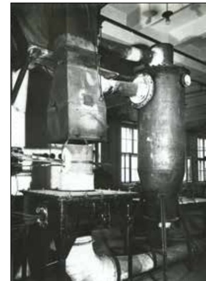
Skupina tepelně-technického výzkumu. Pokusné laboratorní zařízení pro výzkum procesu spalování ve vrstvě paliva na roštu, vytvořené v roce 1951. Fotografie z výroční zprávy ústavu za rok 1952 NA, fond MPE, k. 110, inv. č. 84
