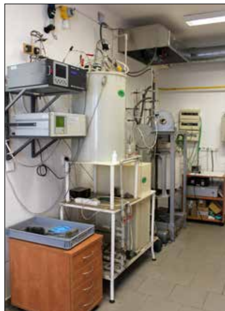
Pec se stacionárním ložem a druhým stupněm pro tepelné zpracování organických odpadních materiálů (Olga Bičáková). Foto: Vlasta Mádlová
