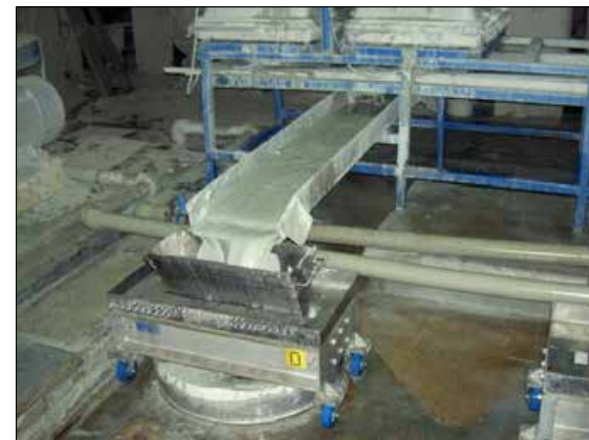
Provozní magnetický filtr v technologické lince přípravy keramické lící hmoty ÚSMH AV ČR
