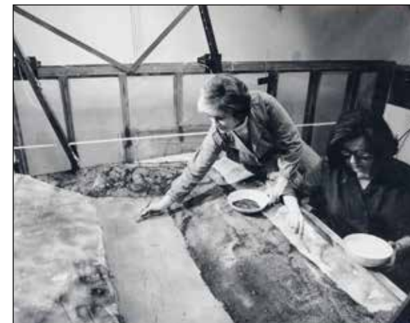
Měření stability dna lomu Jiří na Sokolovsku na modelu, Eva Jeníková, Hana Košťálová, foto: autor neuveden ÚSMH AV ČR, sbírka fotografií
