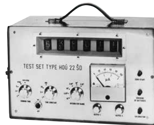
Důlní karotážní souprava gama-gama pro důlní karotáž malopřůměrových vrtů vedených přímo z důlních děl. Typ HOÚ 22 ŠD byl plně tranzistorovaným, bateriovým měřicím zařízením s číslicovým osazením vyhodnocovací části, bez datace, foto: autor neuveden ÚSMH AV ČR, sbírka fotografií
