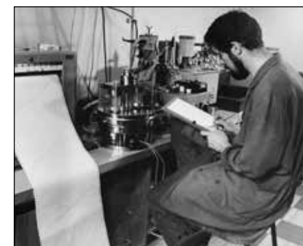
Petr Glogar při měření teplotní vodivosti vzorků hornin z příbramského uranového ložiska. Měření této veličiny bylo zásadní pro ... Přístroj P. Glogar vyvinul a zkonstruoval. ÚSMH AV ČR, sbírka fotografií
