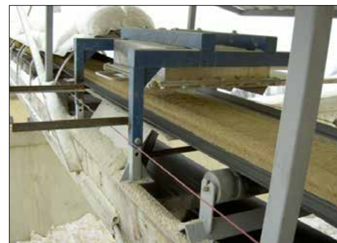
Magnetický odlučovač nečistot nad dopravním pásem surovinové směsí ÚSMH AV ČR
