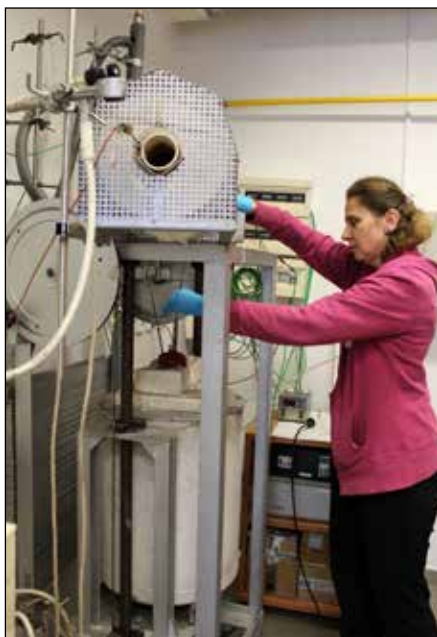
Pec se stacionárním ložem a druhým stupněm pro tepelné zpracování organických odpadních materiálů (Olga Bičáková). Foto: Vlasta Mádlová
